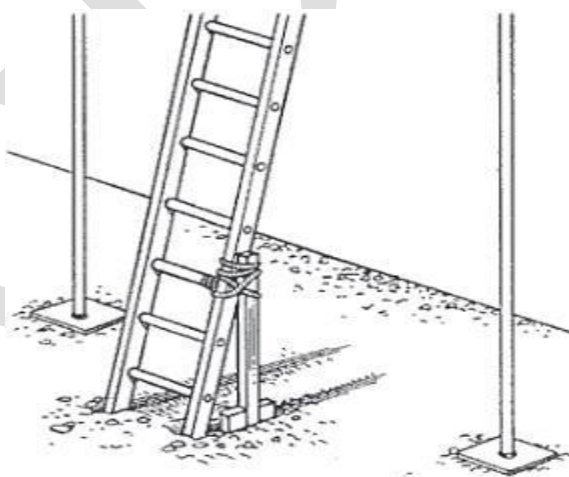
Hình 9.2. Buộc chặt chân thang chống di trượt
