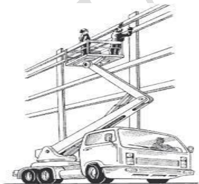
Hình 4.1. Buộc chặt thang cầu vào khung thép
