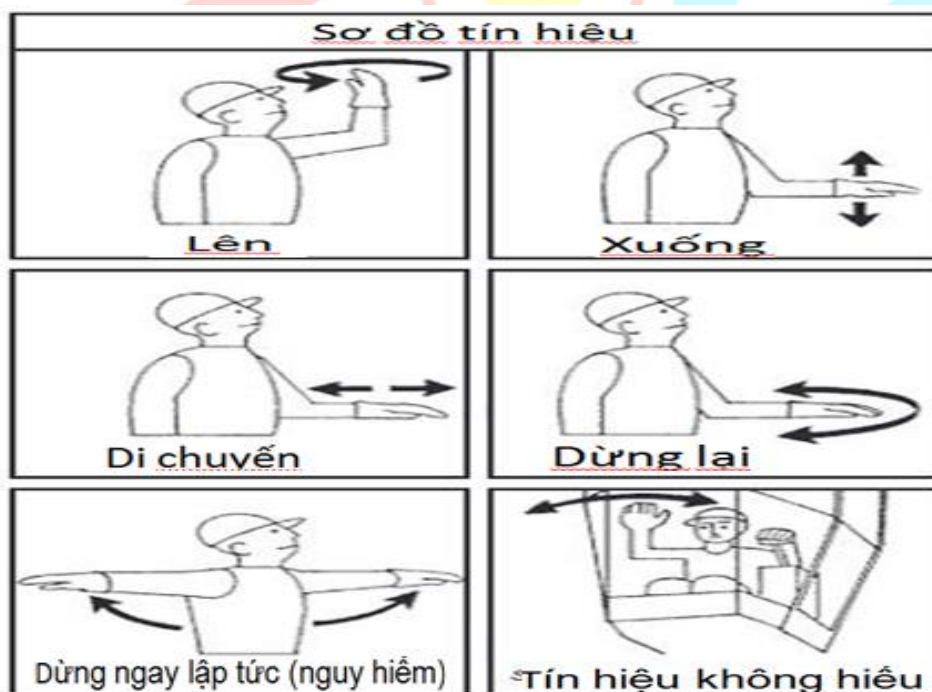
Hình 2.1. Các tín hiệu thông báo bằng tay của người điều khiển cần trục
