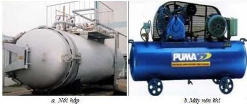
Hình 2.1. Nồi hơi và thiết bị áp lực
